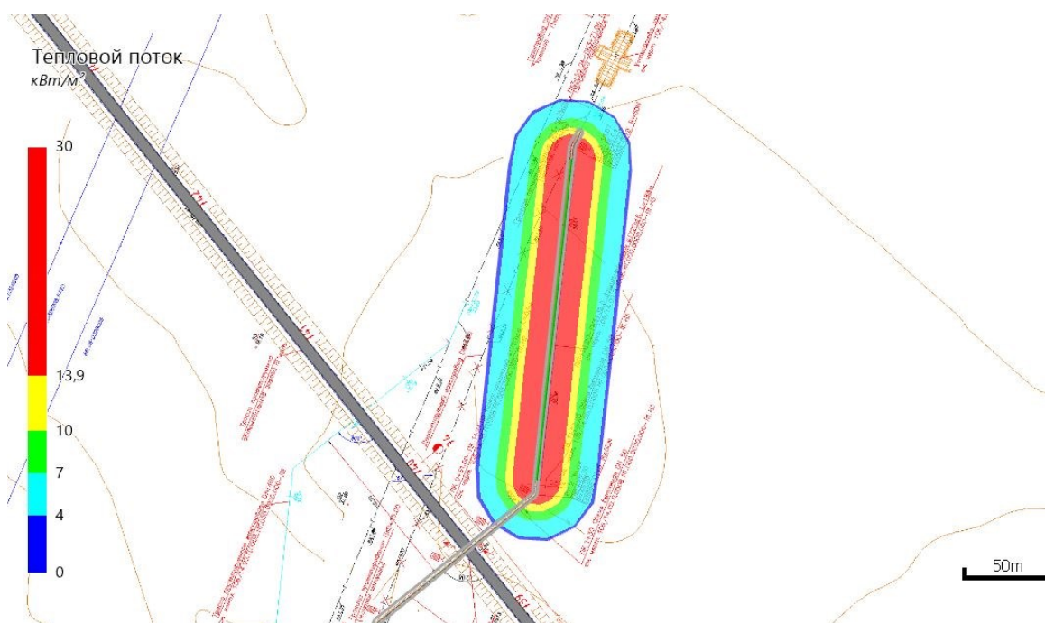
Поле величин теплового потока ПК1+51 - ПК3+39
