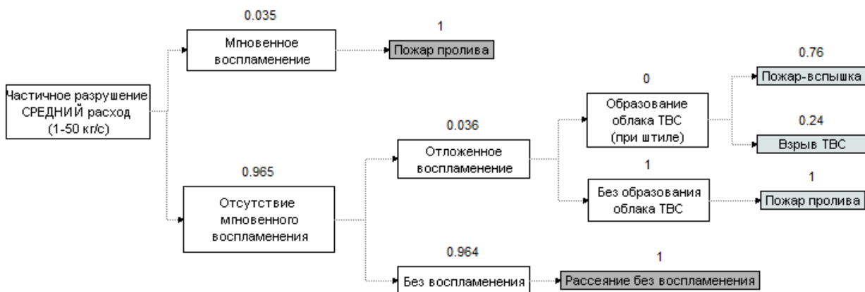
Рис. 2.2. Дерево событий при возникновении и развитии пожароопасной ситуации, связанной с разгерметизацией резервуара или трубопровода (при среднем расходе истечения жидкости)
